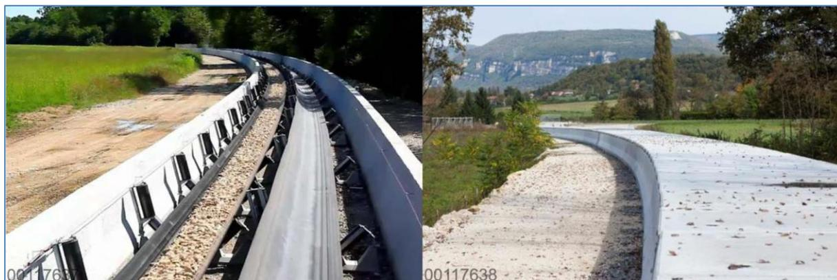
Figure 1.3-8 Exemple de convoyeur à bande en caisson béton
